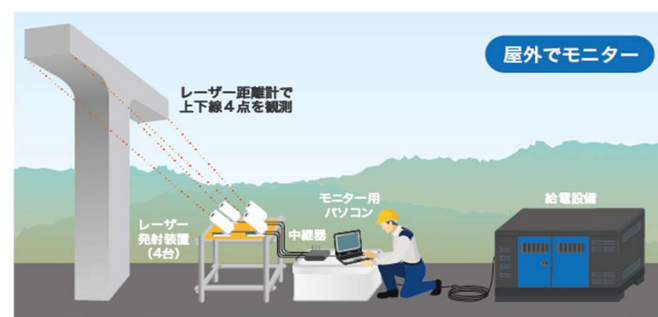
図 1 従来の計測イメージ（有線方式による計測）
