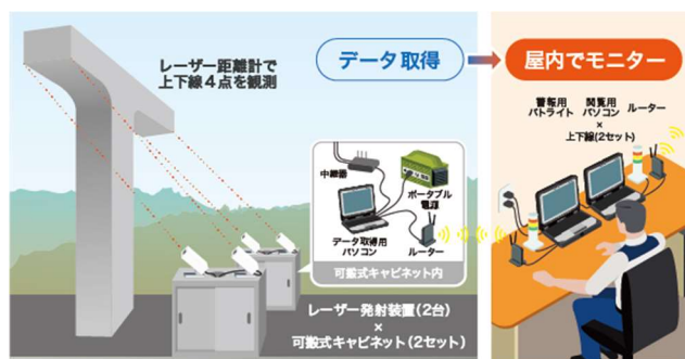
図2 今回の計測イメージ（無線方式による計測）
