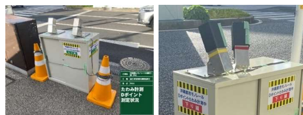
写真2 可搬式キャビネットと距離計へのフード設置状況
