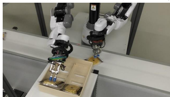
写真 2 コンベアトラッキングによる箱詰め動作の様子
